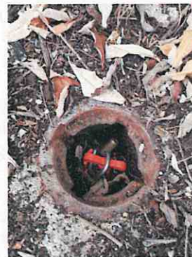
Piézomètre PZ3 Absence de capot, présence d'une vanne étanche cadennassable
