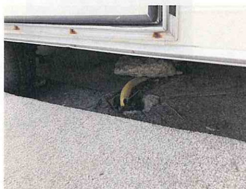
Piézomètre NPZ10 Ouvrage utilisé pour la vidange des eaux usées de la caravane installée au-dessus.
